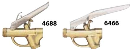
**Válvula de Gatilho 4688** com trava. Vazão máx. de 7,6 l/min (2 GPM), pressão máx. de 17 bar (250 PSI). Conexão de entrada (F) de ¼ pol. NPT (F), conexão de saída 1/16 pol.-16 (M). Uso com pontas TeeJet e ConeJet®, pontas ConeJet ajustáveis ou pontas MulteeJet®. Material: latão.
