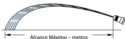
Os dados acima baseiam-se na pulverização de água de uma altura de cerca de 0,75 metros (2½ pés) com a ponta inclinada como ilustrado à esquerda de cada configuração.
