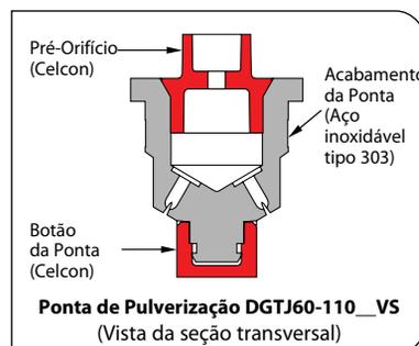
**Observação:** Devido ao projeto do pré-orifício, esta ponta não é compatível com o filtro de ponta com válvula de retenção 4193A.
