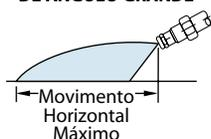
Conforme o gatilho é puxado, a válvula se move da posição fechada para a pulverização de ângulo inicial, para as pulverizações de jatos cônicos mais estreitos,
