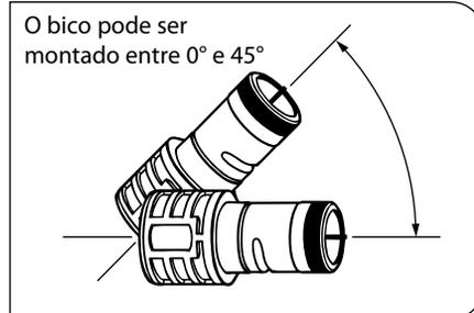
O revolucionário bico Quick Turbo FloodJet combina a precisão e a uniformidade do bico de pulverização de jato plano com o padrão de resistência à obstrução e ângulo grande dos bicos de deflexão. Ele usa um projeto novo exclusivo para aumentar o tamanho da gota e a uniformidade da distribuição.
