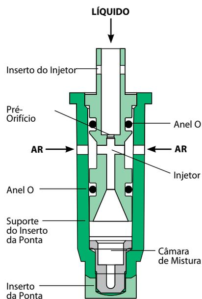
**Observação:** Devido ao projeto do pré-orifício, esta ponta não é compatível com a válvula de retenção 4193A.
