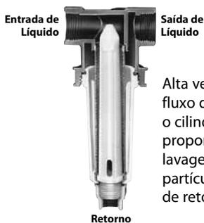
Alta velocidade do fluxo de líquido entre o cilindro e a tela proporciona uma lavagem contínua das partículas para a linha de retorno.
