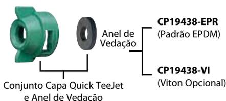
As capas Quick TeeJet são projetadas com canaletas que se encaixam nas ranhuras de posicionamento do corpo do bico. As capas são feitas de náilon e estão disponíveis para uso com todas as pontas TeeJet®. Pressão máxima de operação de 20 bar (300 PSI).
