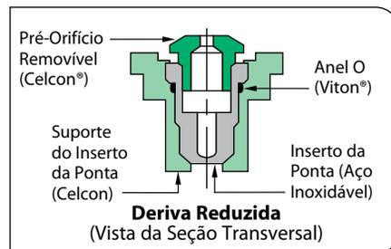
**Observação:** Devido ao projeto do pré-orifício, esta ponta não é compatível com a válvula de retenção 4193A.
