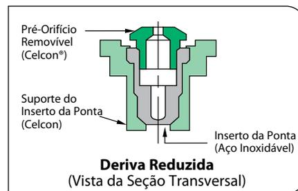
**Observação:** Devido ao projeto do pré-orifício, esta ponta não é compatível com o filtro de ponta 4193A com válvula de retenção.
